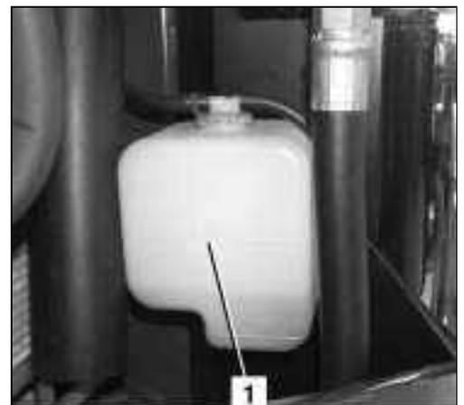
Se il serbatoio compensatore del refrigerante è stato svuotato completamente, si deve controllare il livello del liquido nel radiatore.
