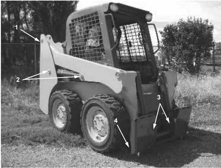
Figura 37 Ingrassare ogni 10 ore di funzionamento (oppure ogni giorno)
