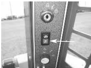
Figura 2 Interruttore del freno di stazionamento – Modelli con DPF sopra, modelli senza DPF sotto
