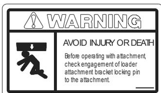
50354117 – Collocato sulla staffa dell'attrezzatura (pale con dispositivo di aggancio manuale e motorizzato)
