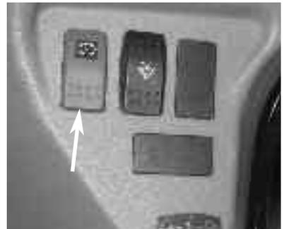
**Figura 2** Interruttore del freno di stazionamento
