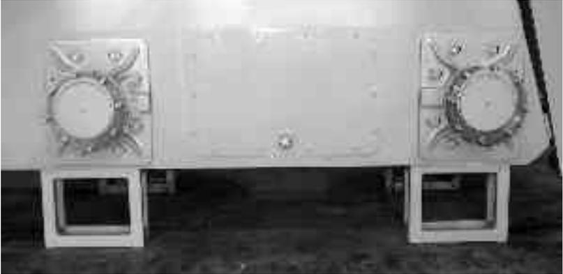
**Figura 32 Pala compatta poggiata correttamente sui blocchi (ruote e pneumatici sono stati tolti per mostrare i blocchi)**
